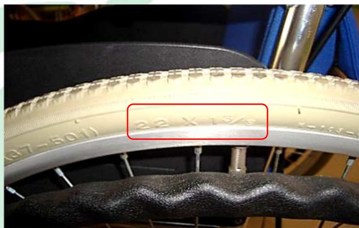
「22×1 $\frac{3}{8}$ 」 or 「22×1」 以外のタイヤの場合、パンクさせた場合や、チューブの劣化が激しい場合交換用の部品がないため、**実技試験**が受けられなくなる可能性があります。
