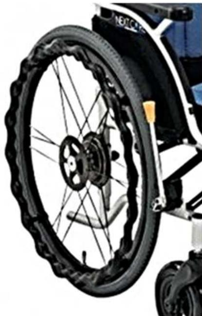
左写真のような、スポークの本数が少ないタイヤ（ディープリム）の場合、中のチューブのバルブの長さが異なります。
